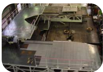
旅客機点検架台
