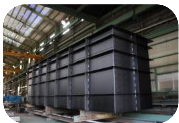
亜鉛メッキ塩酸槽
